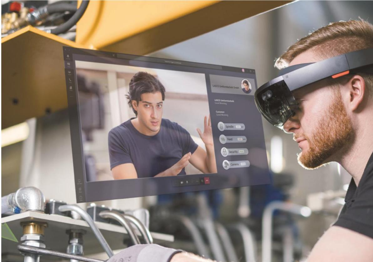
Der Videostream ermöglicht bidirektionale Bild- und Tonübertragung sowie die schnelle und direkte Suche, Erkennung und Behebung von Störungen über die Instandhaltungstechnik des Kunden vor Ort, virtuell begleitet durch den LASCO-Experten in Coburg.
